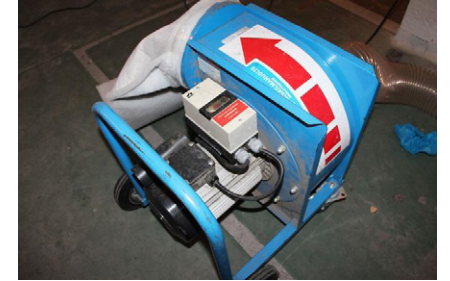
Ilman alipaineistajaa kertynyt lika jää puhdistuksen aikana kanavistoon.
