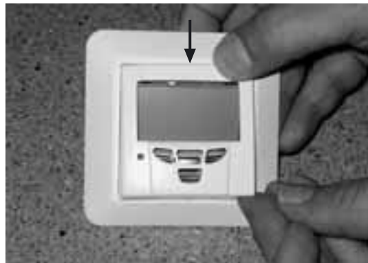
Paneelin kannen kiinnitys ILTO Premium -säätimeen. Aseta ensin kannen yläreuna paikalleen ja paina sitten kansi kiinni.
