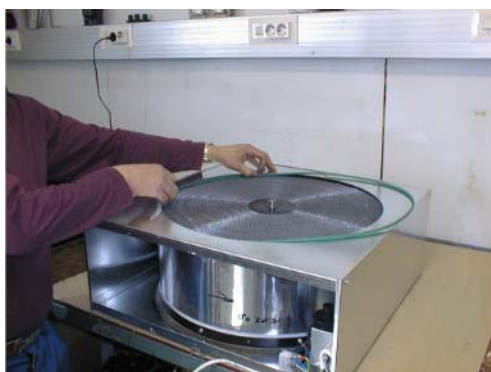
Kuva 3a ja 3b Hihnan pujotus paikoilleen
